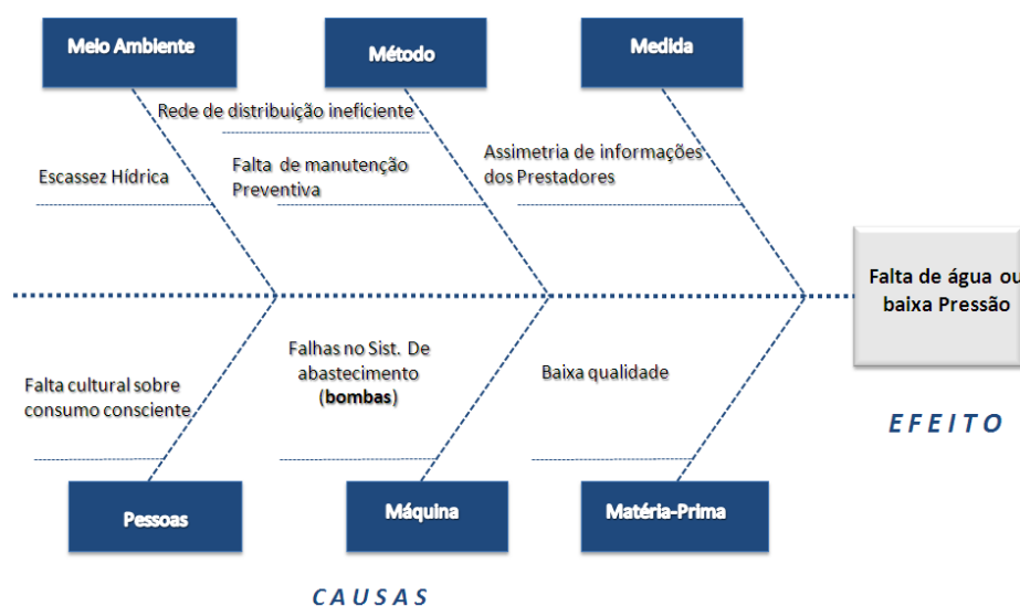
FIGURA 3 – Diagrama de Causa e Efeito ou “espinha de peixe” aplicado aos problemas de falta de água e/ou baixa pressão.
