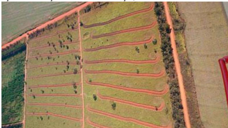
**Figura 6 – Obras mecânicas de conservação do solo - terraços construídos pelo Projeto**
